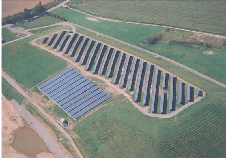
**Abbildung 19: 1,1 MW Fotovoltaikanlage auf der ehemaligen Deponie Wittgensdorf**
