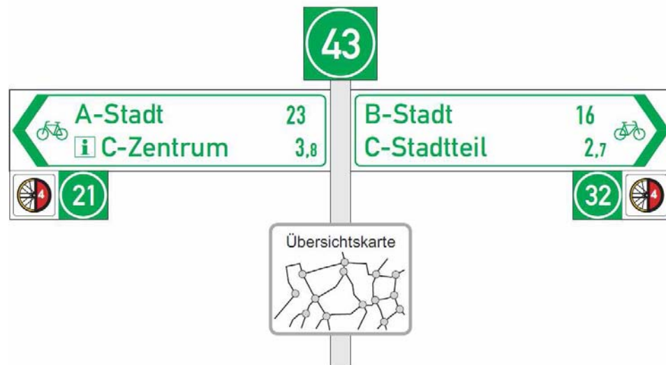
Abbildung 5.2 Ergänzung der Zielwegweiser durch Knotenpunktnummern (Weiß auf grünem Grund)
